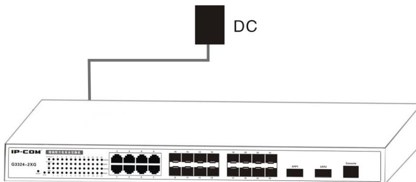
图（七）交换机接 DC 电源
