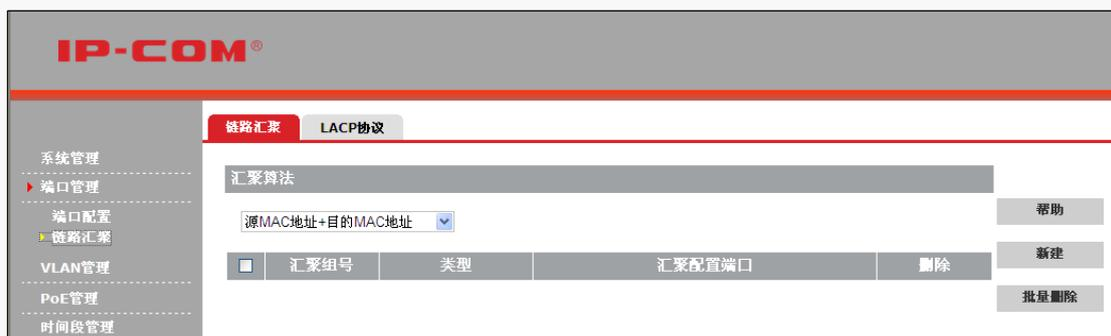
链路汇聚一般有四种物理链路的分配算法。默认情况下，本交换机汇聚组中各成员端口根据源 MAC 地址+目的 MAC 地址进行负荷分担。如图。
