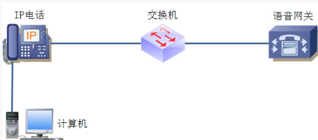
**手动模式：**需要管理员手动把 IP 电话接入端口加入到语音 VLAN 中。再通过识别报文的源 MAC，匹配 OUI 地址。匹配成功后，系统将下发 ACL 规则、配置报文的优先级。端口的添加/删除到语音 VLAN 的过程由管理员手动实现。手动模式适用于 IP 电话单独接入（端口仅传输语音报文）的组网方式，如下图。该组网方式可以使该端口专用于传输语音数据，最大限度避免业务数据对语音数据传输的影响。
